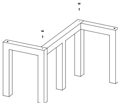
**4.** Insérer une vis dans une rondelle, visser le tout au bois puis recouvrir d'un cache-vis.
