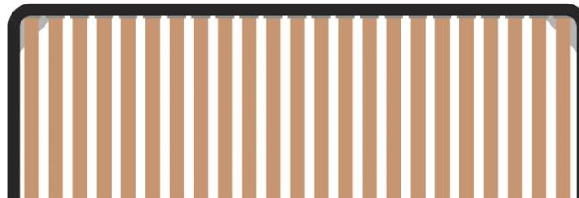
**STANDARD:** Rete con telaio rettangolare, angoli arrotondati e verniciature in polveri epoxi poliestere cotta a 180°C. Doghe in faggio sagonato a caldo, infilati in appositi alloggiamenti ricavati nel telaio 50x25mm. Elementi di fissaggio in plastica.
